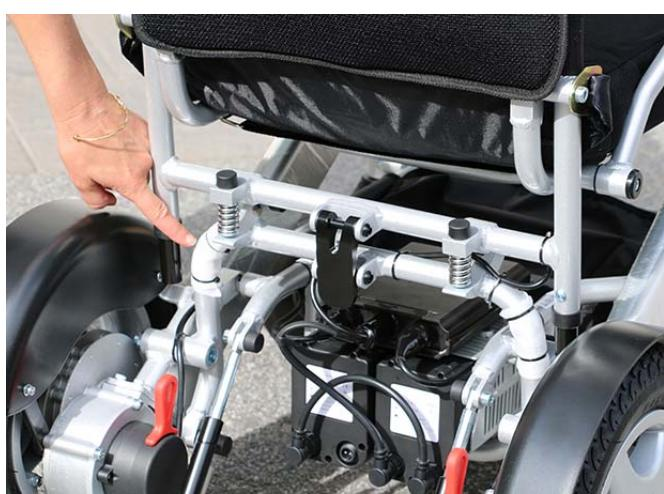
**6** Fjern transportbeskyttelsen på den bakre buen over motorerene ved å klippe den av med en avbitertang.
