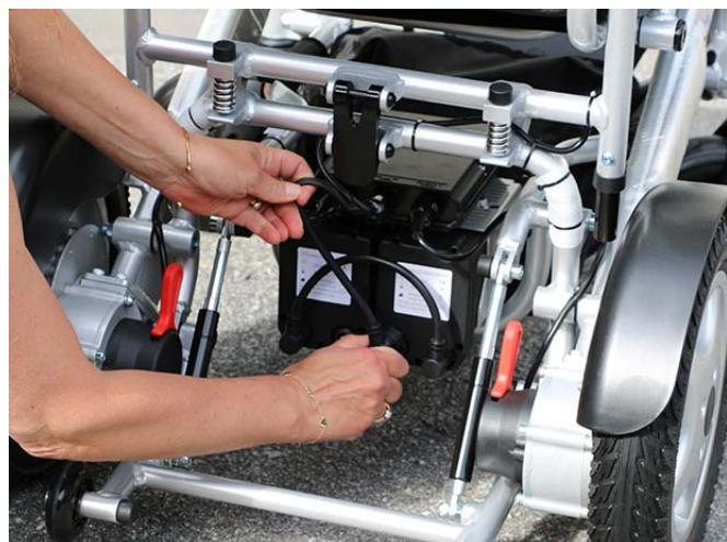
**4** Monter den løse kabelen på valgfri ledig kontakt på batteriet. Skru til låseringen ordentlig på kontakten.
