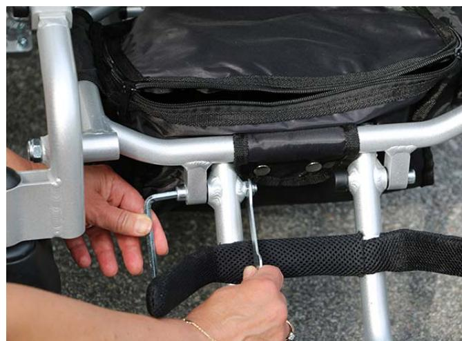
**12** Fotplatens treghet kan enkelt justeres ved at de to festeskruene dras til eller løsnes. Du kan deretter låse mutteren med loctite. Se bilde.
