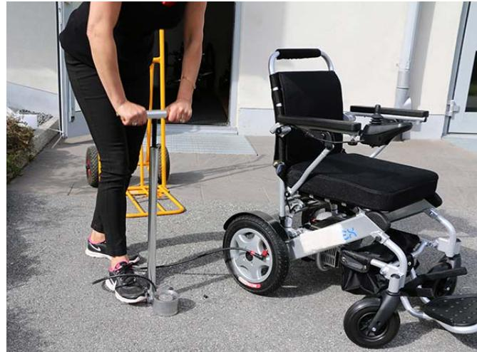
**10** Pump bakhjulene på modellene L-Plus og M-Plus til 2,5 kg lufttrykk.
