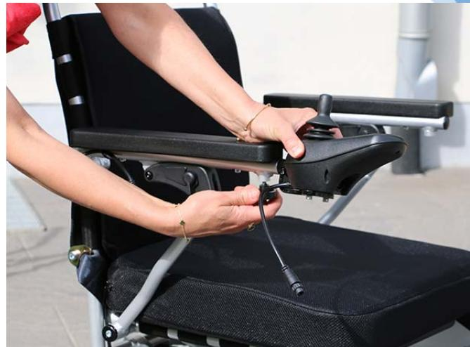
**8** Monter joysticken på valgfri side. Dra til festeskruen slik at joysticken ikke kan beveges.
