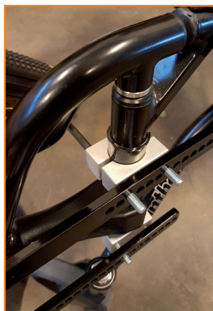
7. Sett på adapteret på klemmene.
