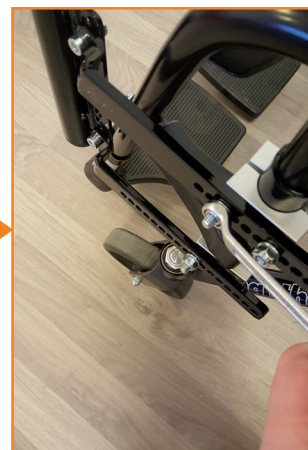
9. Skru deretter til skruene og gjenta prosedyren på andre siden.
