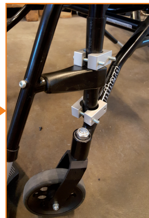
6. Sett deretter på klemmene rundt røret.
