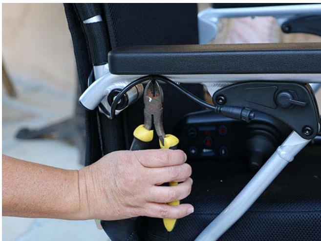
**3** Klipp av stripsen under armlenet med en avbitertang. OBS! Pass på kabelen.
