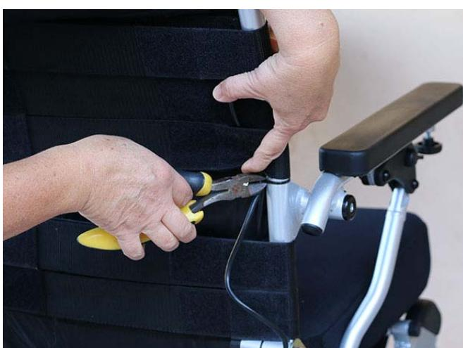
**5** Klipp av stripsen på høyre ryggstolpe ved hjelp av en avbitertang. Obs igjen, pass på kabelen.
