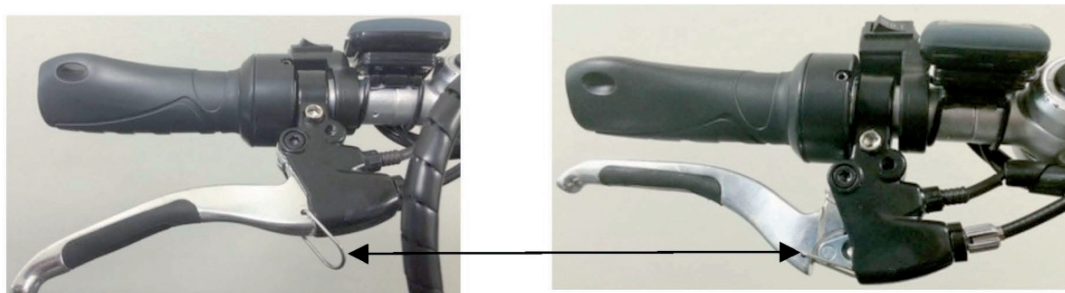
Høyre bremsehåndtak har P-bremse -kroken bøyes inn og låser av bremsen.
